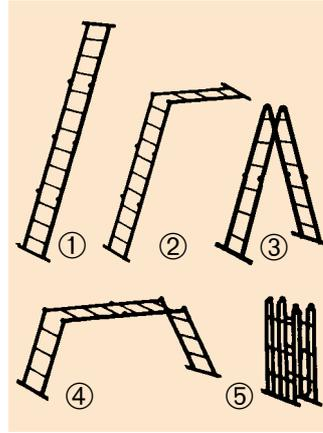
Dank verschraubter Automatikscharniere mit ein paar Handgriffen einsetzbar als:
